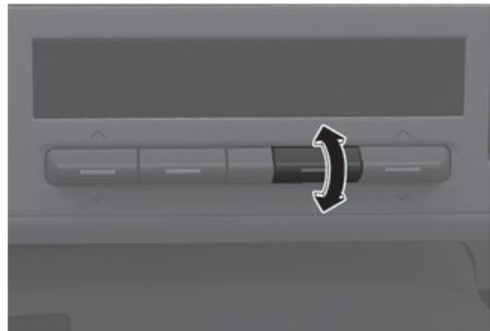
Le commutateur de sélection de mode contrôle la direction du flux d'air dans le système de ventilation.
