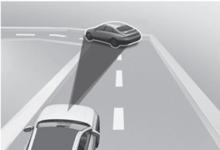
La vitesse de votre véhicule peut être réduite à cause d'un véhicule dans la voie adjacente.
