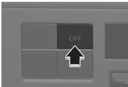
Appuyez sur la touche OFF pour désactiver le système de climatisation. Cependant, vous pouvez toujours utiliser les boutons de mode et de débit d'air tant que le bouton ENGINE START/STOP (démarrage / arrêt du moteur) est en position ON (marche).
