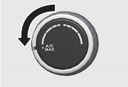
Le mode MAX A/C est utilisé pour refroidir plus rapidement l'intérieur du véhicule. Le flux d'air est dirigé vers le haut du corps et le visage.
