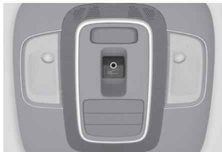
Le toit ouvrant peut uniquement être actionné lorsque le bouton de démarrage/arrêt du moteur est en position ON ou START.
