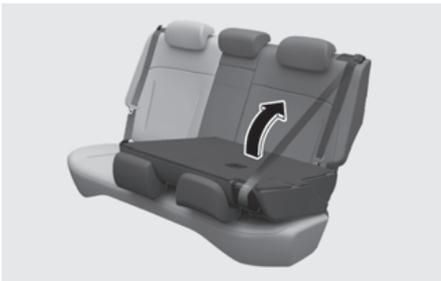
2. Poussez fermement le dossier du siège jusqu'à ce qu'il s'enclenche en position. Assurez-vous que le dossier du siège est verrouillé en position.
