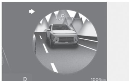
L'écran d'affichage de l'angle mort utilise les caméras à vue latérale large pour afficher les zones d'angle mort arrière de votre véhicule sur le combiné d'instruments lorsque le clignotant est activé pour faciliter les changements de voie en toute sécurité.
