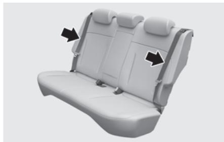
4. Tirez sur le levier de rabattement du dossier de siège, puis rabattez le siège vers l'avant du véhicule.
