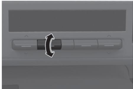
Poussez l'interrupteur vers le haut pour augmenter la vitesse du ventilateur et le débit d'air. Poussez l'interrupteur vers le bas pour réduire la vitesse du ventilateur et le débit d'air.
