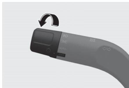
Le feu de position et les phares s'allument ou s'éteignent automatiquement en fonction de la lumière du jour mesurée par le capteur de lumière ambiante situé au centre du tableau de bord lorsque le frein de stationnement n'est pas engagé et que le levier de vitesses n'est pas en position P (Stationnement).
