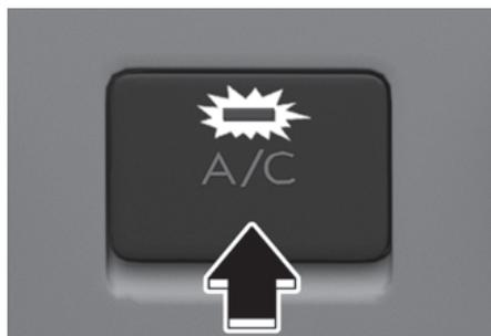
Appuyez sur le bouton A/C pour mettre en marche le système de climatisation (témoin lumineux allumé). Appuyez à nouveau sur le bouton pour désactiver le système de climatisation.
