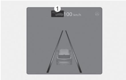
1. Indicateur d'aide à la conduite sur l'autoroute – indique s'il y a un véhicule devant vous et le niveau de distance sélectionné.
