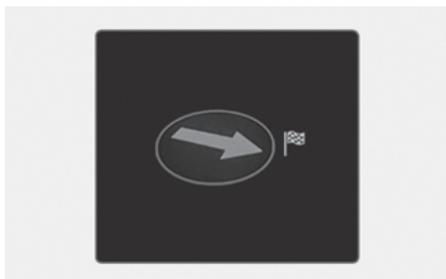
La navigation virage par virage et la distance/temps jusqu'à la destination s'affichent lorsque le mode virage par virage est sélectionné.
