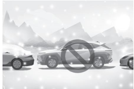
La neige peut interférer avec le fonctionnement du capteur ou le système d'aide au stationnement intelligent télécommandé peut annuler si la route est glissante pendant le stationnement.
