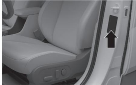
L'étiquette de certification du véhicule apposée sur le montant central côté conducteur (ou côté passager avant) indique le numéro d'identification du véhicule (VIN).
