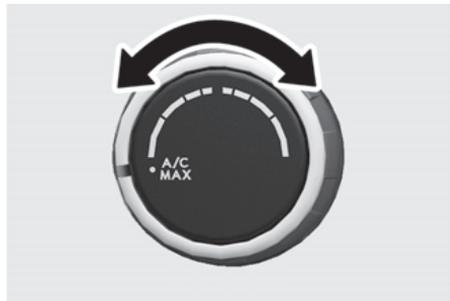
La température augmente en tournant le bouton vers la droite. La température diminue en tournant le bouton vers la gauche.
