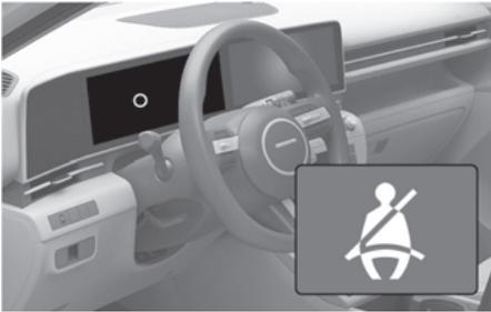
Pour rappeler au conducteur que le témoin de la ceinture de sécurité du conducteur s'allume pendant environ 6 s chaque fois que le bouton Démarrage/Arrêt du moteur est en position ON, que la ceinture de sécurité soit attachée ou non.
