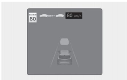
L'assistant manuel de limitation de vitesse ou le régulateur de vitesse intelligent aide le véhicule à adapter sa vitesse en fonction de la limitation de vitesse. Lorsque la vitesse de croisière est identique à la limite de vitesse, le véhicule ajuste automatiquement sa vitesse si la limite de vitesse change. Cette fonction fonctionne sur les routes dont la vitesse est limitée à 70 km/h (45 mph) ou plus. Lorsque la fonction est active, la vitesse
