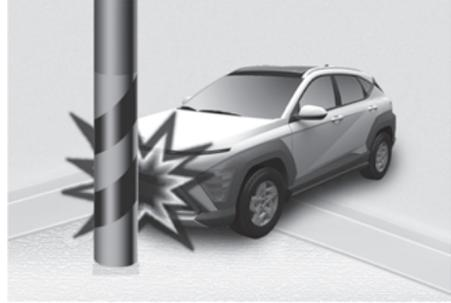
Les coussins gonflables peuvent ne pas se gonfler si le véhicule heurte des objets tels que des poteaux ou des arbres, où le point d'impact est concentré et l'énergie d'impact absorbée par la structure du véhicule.
