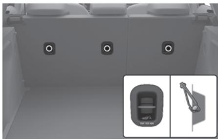
Commencez par assujettir le système de retenue pour enfant au moyen des ancrages inférieurs LATCH ou au moyen de la ceinture de sécurité. Si le fabricant du système de retenue pour enfant recommande que la sangle d'attache supérieure soit fixée, fixez et serrez la sangle d'attache supérieure à l'ancrage de sangle d'attache supérieure.
