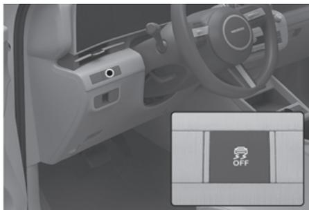
Le système de contrôle électronique de la stabilité (ESC) aide à stabiliser le véhicule dans les virages.
