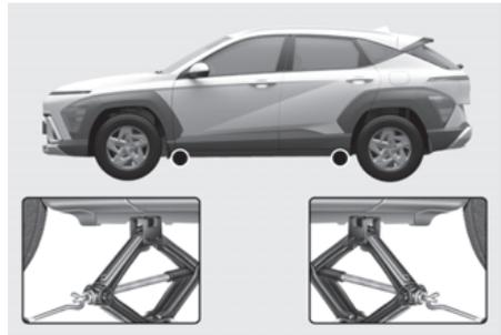
8. Insérez la manivelle dans le cric et tournez-la dans le sens horaire, en soulevant le véhicule jusqu'à ce que le pneu soit dégagé du sol. Assurez-vous que le véhicule est stable sur le cric.
