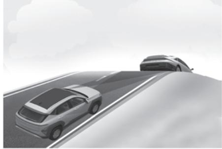
Dans les montées ou dans les descentes, le régulateur de vitesse intelligent peut ne pas détecter un véhicule dans votre voie, et votre véhicule pourrait accélérer jusqu'à la vitesse définie. Également, la vitesse du véhicule diminue rapidement lorsque le véhicule qui précède est reconnu brusquement.
