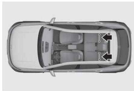
Des ancrages LATCH ont été prévus aux places arrière extérieures gauche et droite. Leur emplacement est indiqué sur l'illustration. Il n'y a pas d'ancrages LATCH prévus pour le siège arrière central.
