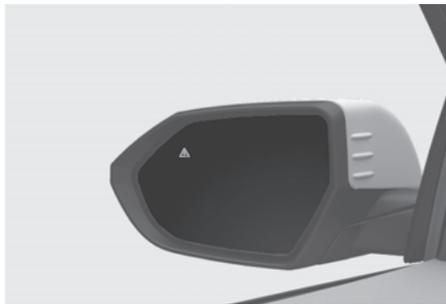
Pour avertir le conducteur qu'un véhicule est détecté, le témoin lumineux du rétroviseur latéral s'allume.
