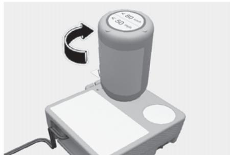
3. Assurez-vous que la valve du compresseur sur le tuyau de remplissage est verrouillée.
