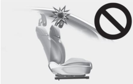
Si vous inclinez le dossier de siège vers l'avant avec l'appuie-tête et le coussin de siège relevés, l'appuie-tête peut toucher le pare-soleil ou d'autres parties du véhicule.
