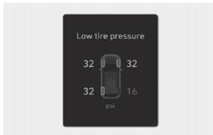
Ce message d'avertissement s'affiche si la pression des pneus est faible. Le pneu correspondant sur le véhicule s'allume.
