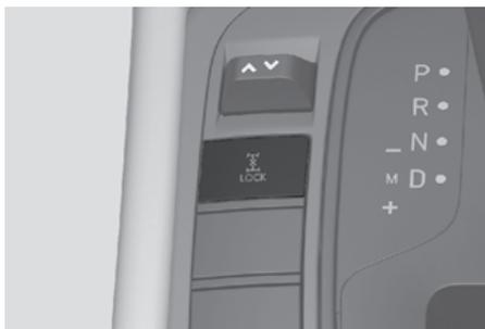
Le système de transmission intégrale (AWD) transmet la puissance du moteur à toutes les roues avant et arrière pour une traction maximale. La transmission intégrale est utile lorsqu'une traction supplémentaire est nécessaire sur des routes glissantes, boueuses, humides ou enneigées.
