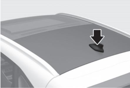
L'antenne en forme d'aileron de requin reçoit les données transmises (par exemple, AM/FM, SXM).
