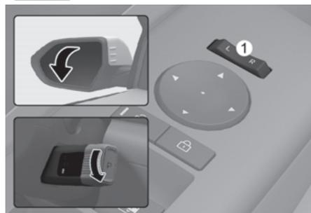
Lorsque le levier de vitesse est en position R (marche arrière), les rétroviseurs extérieurs pivotent vers le bas pour faciliter la conduite en marche arrière.
