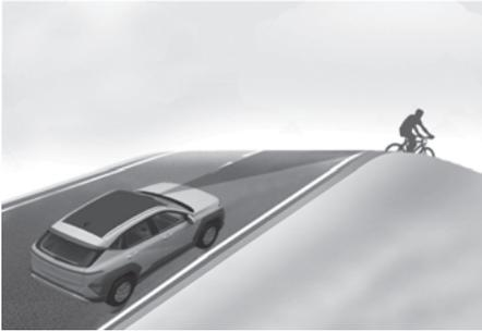
L'assistance à l'évitement de collision frontale peut ne pas détecter un véhicule, un deux-roues motorisé, un piéton ou un cycliste devant vous lorsque vous roulez en montée ou en descente, ce qui affecte les performances des capteurs.
