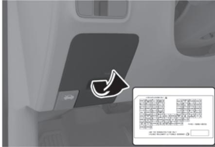
À l'intérieur du couvercle du panneau de fusible, vous trouverez l'étiquette des fusibles/relais décrivant les noms et les valeurs nominales des fusibles/relais.
