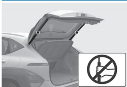
Fermez toujours le hayon avant de conduire. Ne pas saisir ou s'accrocher aux montants de soutien du hayon, car ils risquent d'être endommagés. La déformation des supports de hayon peut entraîner des dommages au véhicule et des blessures corporelles.
