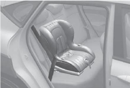
Étant donné que toutes les ceintures de sécurité des passagers se déplacent librement dans des conditions normales et ne se verrouillent que dans des conditions extrêmes ou d'urgence (mode de verrouillage d'urgence), vous devez tirer manuellement la ceinture de sécurité jusqu'au bout pour faire passer l'enrouleur en mode de « verrouillage automatique » afin de fixer un système de retenue pour enfants.
