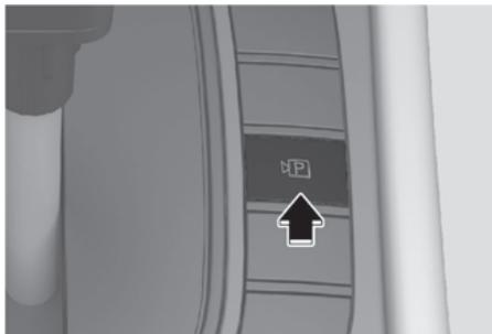
Appuyez sur le bouton Parking/View (1) lorsque la vitesse est en P (Stationnement), D (Marche avant) ou N (Point mort) pour activer le Moniteur de vue arrière.
