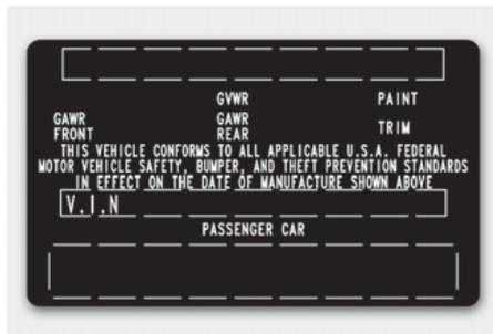
L'étiquette d'homologation se trouve sur le seuil de la porte du conducteur au montant central et indique le poids maximal autorisé du véhicule complètement chargé. Ceci s'appelle le poids nominal brut du véhicule. Le poids nominal brut du véhicule inclut le poids du véhicule, de tous les occupants, du carburant et du chargement.
