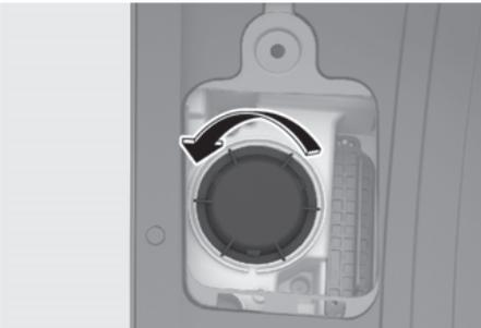
5. Retirez l'ampoule de la douille en l'enfonçant et en la tournant dans le sens inverse des aiguilles d'une montre.
