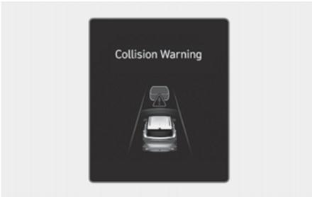
Lorsque le régulateur de vitesse intelligent fonctionne et que le risque de collision avec le véhicule qui précède est élevé, le message d'avertissement « **Avertissement de collision** » s'affiche sur le combiné d'instruments et un signal sonore retentit pour avertir le conducteur. Soyez toujours attentif à la route et pendant la conduite et, si nécessaire, appuyez sur la pédale de frein pour ralentir afin de maintenir une distance de sécurité.
