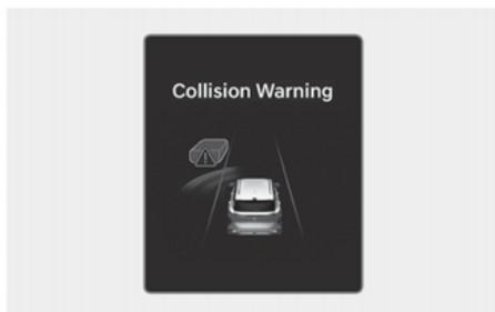
Pour avertir le conducteur d'une collision, le message d'avertissement « **Collision Warning** » s'affiche et le témoin (⚡) clignote sur le combiné d'instruments avec un son d'avertissement et le volant vibre.
