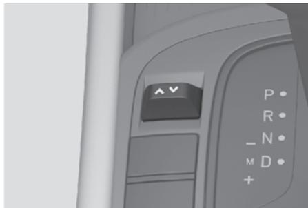
Le mode de conduite peut être sélectionné en fonction des préférences du conducteur ou de l'état de la route.
