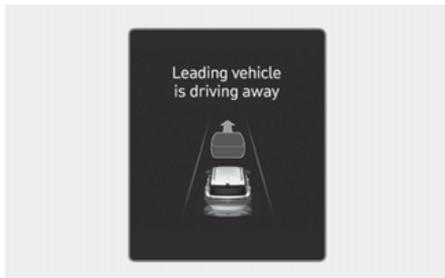
Lorsqu'un véhicule détecté à l'avant quitte l'arrêt, l'alerte de départ du véhicule de tête informe le conducteur en affichant le message « **Le véhicule de tête s'éloigne** » sur le combiné d'instruments et en émettant un avertissement sonore.
