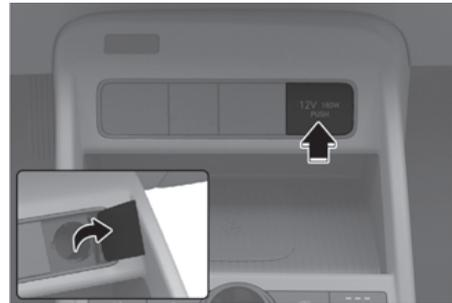
La prise de courant est conçue pour alimenter les téléphones portables ou d'autres appareils conçus pour fonctionner avec les systèmes électriques du véhicule.
