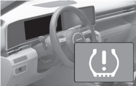
Le témoin de dysfonctionnement du système de surveillance de la pression des pneus (⚠) s'allume après avoir clignoté pendant environ une minute en cas de problème avec le système de surveillance de la pression des pneus.
