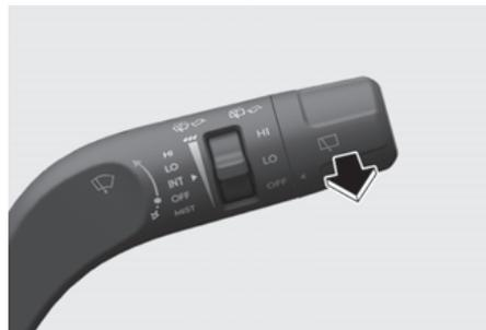
En position OFF, tirez légèrement le levier vers vous pour pulvériser du liquide lave-glace sur le pare-brise et pour faire fonctionner les essuie-glaces sur 1 à 3 cycles. La pulvérisation et l'essuyage se poursuivent jusqu'à ce que vous relâchiez le levier. Si le lave-glace ne fonctionne pas, vous devrez peut-être ajouter du liquide de lave-glace dans le réservoir de lave-glace.
