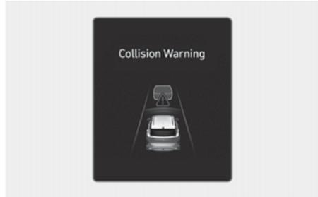
Pour avertir le conducteur d'une collision, le message d'avertissement « **Collision Warning** » s'affiche et le témoin (🚨) clignote sur le combiné d'instruments avec un son d'avertissement et le volant vibre.
