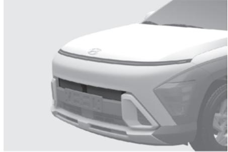
Le système de volet d'air actif contrôle le volet d'air situé sous le pare-chocs avant pour refroidir les pièces du véhicule et améliorer l'efficacité énergétique.
