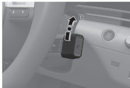
C'est la position normale de conduite en marche avant. La transmission passe automatiquement au rapport de vitesse optimal, ce qui se traduit par un meilleur rendement énergétique et une conduite plus souple.
