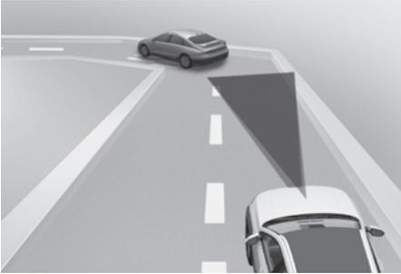
Dans les virages, le régulateur de vitesse intelligent peut ne pas détecter un véhicule qui se déplace sur la même voie et votre véhicule pourrait accélérer jusqu'à la vitesse définie. Également, la vitesse du véhicule peut diminuer rapidement lorsque le véhicule qui précède est reconnu brusquement.
