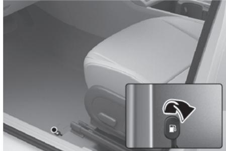
3. Tirez le volet du réservoir à carburant (1) vers l'extérieur pour accéder au bouchon du réservoir de carburant.
