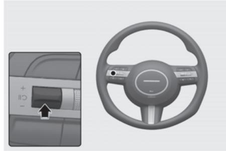
Appuyez sur l'interrupteur **LIMIT OFF** pour mettre temporairement en pause la limite de vitesse définie. La limite de vitesse définie s'éteint, mais le témoin de limite de vitesse (**LIMIT**) reste allumé.
