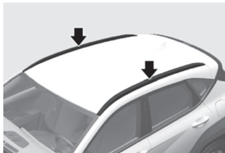
Votre véhicule peut être équipé de barres latérales de toit. Si votre véhicule est équipé d'une galerie de type rails, vous pouvez ajouter des barres transversales de toit en tant qu'accessoire (non illustré).
