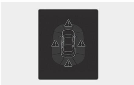
Lorsque l'avertissement de distance de stationnement fonctionne, si la fonction ne fonctionne pas normalement ou si le capteur à ultrasons est bloqué, le témoin principal (Δ) s'allume dans la direction du capteur correspondant. Vous pouvez
