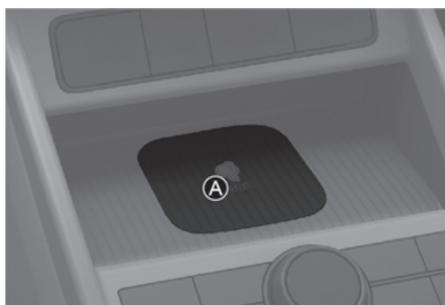
[A] Borne d'authentification intégrée au véhicule (borne de charge sans fil)
