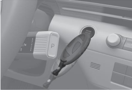
Si la pile de la clé intelligente est faible ou si la clé intelligente ne fonctionne pas correctement, appuyez sur le bouton Engine Start/Stop avec la clé intelligente.
