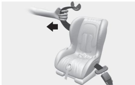
4. Laisser la partie baudrier de la ceinture de sécurité se rétracter lentement et écouter un « déclic » ou un « cliquetis » audible. Ceci indique que l'enrouleur est en mode « verrouillage automatique ». Si rien ne s'entend, répétez les étapes 3 et 4.
