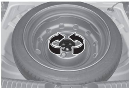
Tournez le boulon de maintien à ailettes dans le sens anti-horaire pour retirer la roue de secours.
