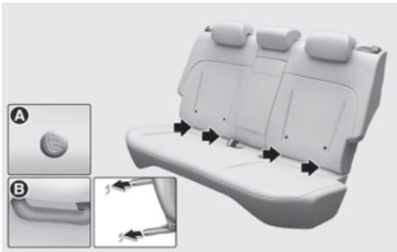
[A] Indicateur de position de l'ancrage inférieur
