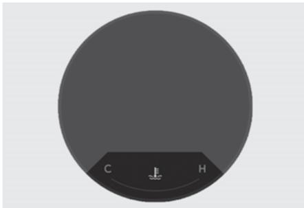
La jauge de température du liquide de refroidissement du moteur indique la température du liquide de refroidissement du moteur lorsque le bouton Engine Start/Stop est en position ON.
