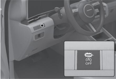
Appuyez sur le bouton ISG OFF pour désactiver le système ISG. Le voyant du bouton ISG OFF s'allume. Pour utiliser le système, appuyez à nouveau sur le bouton ISG ARRÊT (OFF).
