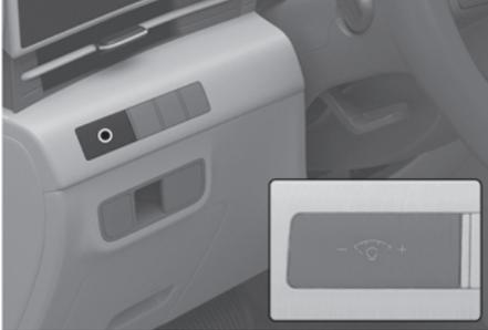
Lorsque les feux de stationnement ou les phares du véhicule sont allumés, appuyez sur le commutateur de commande d'éclairage pour régler la luminosité de l'éclairage du tableau de bord.
