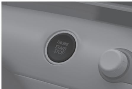
Chaque fois que la portière avant est ouverte, le bouton de démarrage/arrêt du moteur s'allume et s'éteint pendant quelques secondes après la fermeture de la portière.
