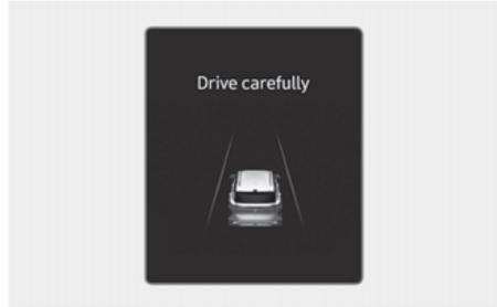
Lorsque le véhicule est arrêté en raison d'un freinage d'urgence, le message d'avertissement « **Conduisez prudemment** » s'affiche sur le combiné d'instruments.
