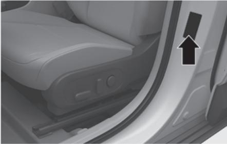
Les spécifications (de taille et de pression) sont indiquées sur une étiquette apposée sur le pilier central du véhicule, côté conducteur.
