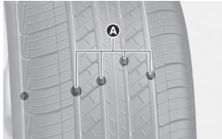
[A] Indicateur d'usure de bande de roulement
