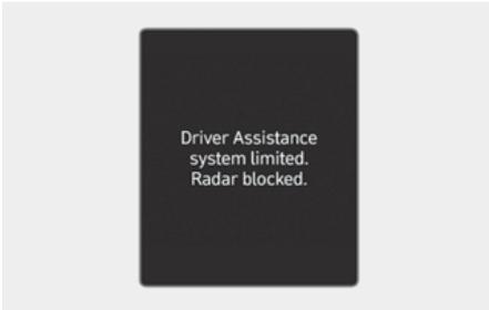
Lorsque le couvercle du radar avant ou le capteur est recouvert de neige, de pluie ou de corps étrangers, il peut réduire les performances de détection et limiter ou désactiver temporairement le Régulateur de vitesse intelligent.
