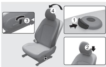
1. Inclinez le dossier du siège en appuyant sur le levier ou le commutateur d'inclinaison du dossier (3).
