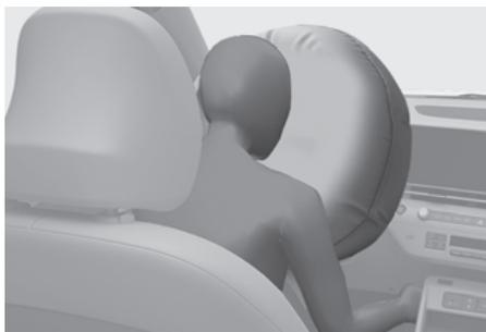
Lors du déploiement, la déchirure de la couverture du coussin se sépare sous l'effet de l'expansion des coussins gonflables.
