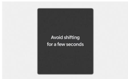
Des accélérations brusques répétées et des démarrages rapides peuvent entraîner une surchauffe temporaire de la transmission. Attendez que le système refroidisse avant d'actionner le bouton rotatif de changement de vitesse.
