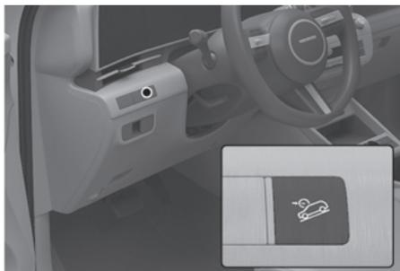
Le système de freinage en descente aide à descendre une pente raide sans avoir à appuyer sur la pédale de frein.
