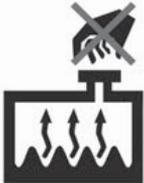
Ne jamais retirer le bouchon du radiateur ou le bouchon de vidange lorsque le moteur et le radiateur sont brûlants. Du liquide de refroidissement chaud et de la vapeur peuvent être projetés sous pression et provoquer des blessures graves.
