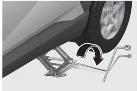
9. Desserrez les écrous de roue à l'aide de la clé à ergots et retirez-les avec les doigts. Retirez la roue des goujons et posez-la à plat sur le sol à l'écart. Enlevez toute saleté ou débris des goujons, des surfaces de montage et de la roue de secours.
