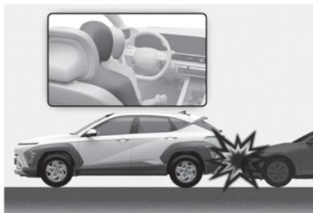
Les coussins gonflables avant ne sont pas conçus pour se déployer en cas de collision arrière parce que les occupants sont projetés vers l'arrière par la force de l'impact.
