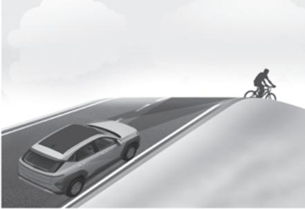
L'assistance à l'évitement de collision peut ne pas détecter un véhicule, un deux-roues motorisé, un piéton ou un cycliste devant vous lorsque vous roulez en montée ou en descente, ce qui affecte les performances des capteurs.
