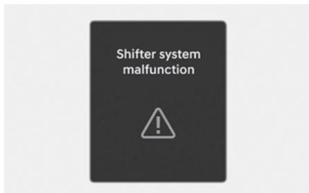
Ce message apparaît lorsque la boîte de vitesses ou le sélecteur de vitesses ne fonctionne pas correctement en position P (Park).
