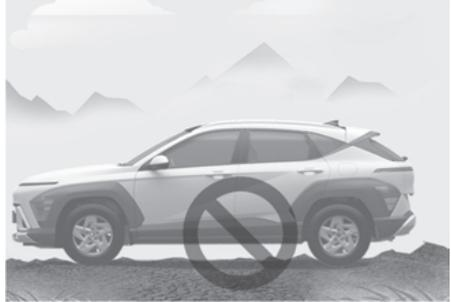
Le système d'aide au stationnement intelligent télécommandé peut s'annuler lorsque le véhicule glisse ou lorsque le véhicule ne peut se déplacer en raison de l'état de la route, comme des cailloux ou des pierres fragmentées.
