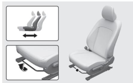
Pour déplacer le siège vers l'avant ou l'arrière :
