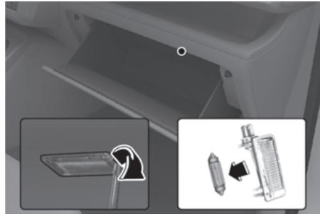
1. À l'aide d'un tournevis à lame plate, extrayez délicatement la lentille du boîtier de la lampe intérieure.
