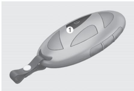
Maintenez le bouton de déverrouillage des portes (1) de la clé intelligente enfoncé pendant plus de 3 secondes et les vitres descendent après le déverrouillage des portes. Le mouvement des vitres s'arrête lorsque vous relâchez le bouton de déverrouillage de la porte.
