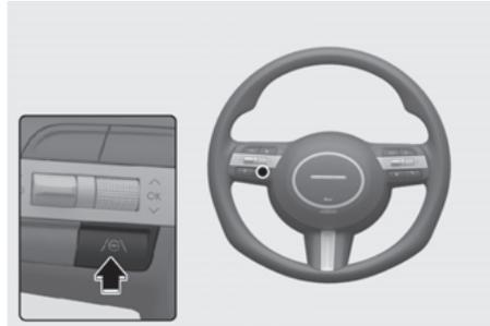
Avec le moteur en marche, appuyez brièvement sur le bouton « Lane Driving Assist » (Aide à la conduite sur la voie) sur le volant pour activer la fonction « Lane Following Assist » (Assistance de suivi de voie). Le témoin gris ou vert (🛞) s'affiche sur le combiné d'instruments.
