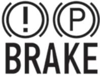
Ce témoin s'allume lorsque le frein de stationnement est serré alors que le bouton de démarrage/arrêt du moteur est en position START ou ON.
