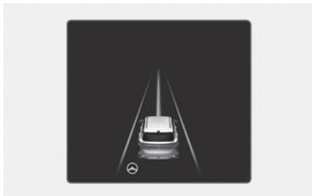
Si le véhicule précédent et/ou les deux marquages de la voie sont détectés et que la vitesse de votre véhicule est inférieure à 200 km/h (120 mi/h), le témoin vert (Ⓢ) s'affiche sur le combiné d'instruments et l'assistance au maintien de la voie aide à centrer le véhicule dans la voie en assistant le volant.
