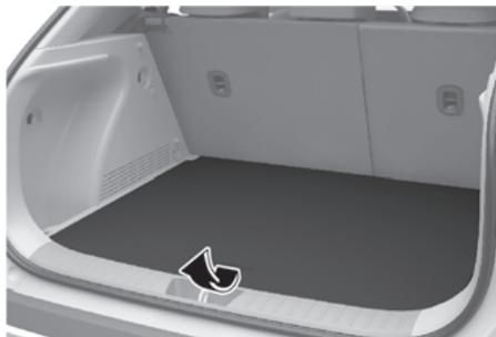
2. Retirez la planche supérieure et insérez-la à fond le long de la rainure inférieure sur les deux côtés.
