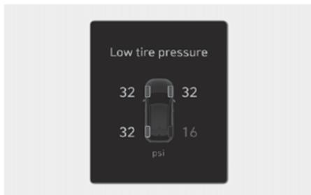
Lorsque le témoin d'avertissement du système de surveillance de la pression des pneus (🚗) s'allume et qu'un message d'avertissement apparaît sur l'écran du combiné d'instruments, cela signifie qu'un ou plusieurs de vos pneus sont nettement sous-gonflés. Le témoin de position de basse pression des pneus indique quel pneu est nettement sous-gonflé en allumant le témoin de position correspondant.
