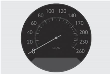
Le compteur de vitesse indique la vitesse du véhicule et il est étalonné en kilomètres par heure (km/h) et/ou en miles par heure (MPH).
