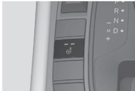
Lorsque le bouton de démarrage/arrêt du moteur est en position ON ou lorsque le moteur tourne, appuyez sur le bouton de chauffage du volant pour le chauffer.
