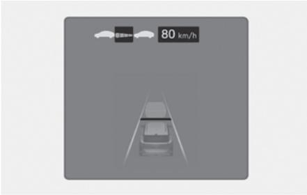
Si vous voulez accélérer temporairement lorsque le régulateur de vitesse intelligent est activé, appuyez sur la pédale d'accélérateur. Pendant que la pédale d'accélérateur est enfoncée, la vitesse, le niveau de distance et la distance cible fixés clignotent sur le combiné d'instruments.
