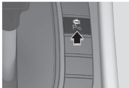
Appuyez sur le bouton Parking Safety (P<sup>PS</sup>) pour activer l'avertissement de distance de stationnement. Pressez le commutateur de nouveau pour mettre le système hors tension.
