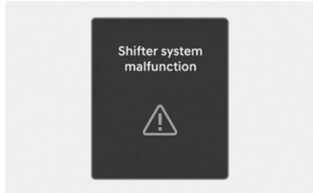
Ce message apparaît lorsque la boîte de vitesses ou le sélecteur de vitesses ne fonctionne pas correctement en position P (Park).
