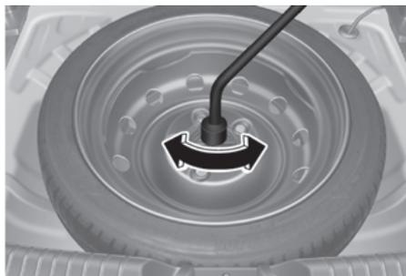
S'il est difficile de desserrer à la main le boulon de l'aile de retenue du pneu, vous pouvez le desserrer facilement à l'aide de la clé à ergots.
