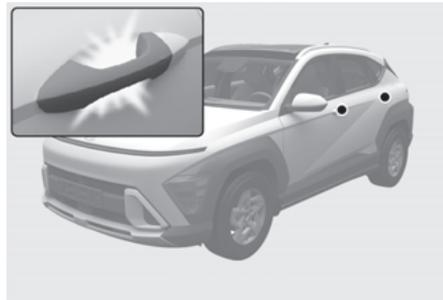
Le système d'accueil permet de garder le conducteur visible en allumant les feux du véhicule lorsque le conducteur s'en approche.
