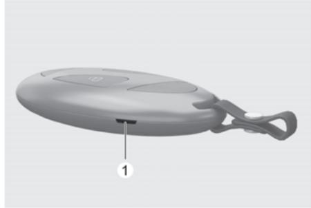
2. Retirez la pile usagée et insérez une pile neuve. Assurez-vous que la position de la pile est correcte.
