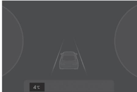
La température ambiante extérieure s'affiche dans la partie inférieure de l'affichage du combiné. La température s'affiche en degrés Fahrenheit ou Celsius, selon les unités sélectionnées dans le menu Paramètres du combiné d'instruments ou du système d'info-divertissement.
