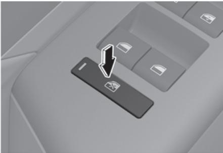
Le conducteur peut désactiver les commutateurs de vitres électriques sur les portières des passagers arrière en appuyant sur le commutateur de verrouillage des vitres électriques.
