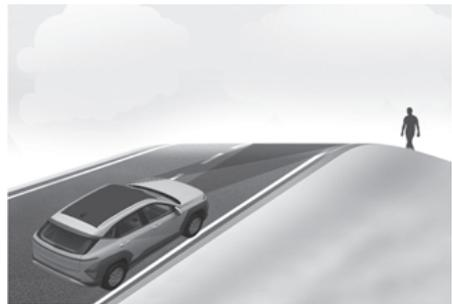
L'assistance à l'évitement de collisions avant peut détecter un véhicule, un deux-roues motorisé, un piéton ou un cycliste sur la voie suivante ou en dehors de la voie lorsque l'on roule sur une route sinueuse.
