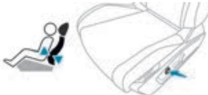
La commande permet de régler indépendamment la profondeur et la hauteur du maintien au niveau des lombaires.
