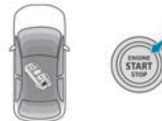
Avec la clé électronique dans l'habitacle, l'appui sur le bouton « **START/STOP** », **sans action sur les pédales**, permet la mise du contact sans démarrer le moteur.
