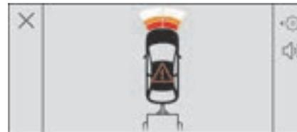
■ L'aide au stationnement arrière est désactivée automatiquement en cas de branchement d'une remorque ou d'un porte-vélo sur un dispositif d'attelage installé selon les préconisations du Constructeur. Dans ce cas, le dessin d'une remorque s'affiche à l'arrière de la représentation du véhicule.
