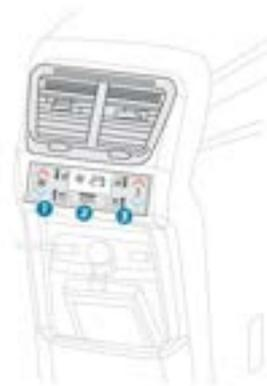
Lorsque la fonction est activée, la soufflante des bouches d'aération arrière démarre. Dans ce cas, les passagers arrière peuvent régler le débit d'air de ces aérateurs indépendamment du réglage de débit d'air du système d'air conditionné pour les aérateurs avant.
