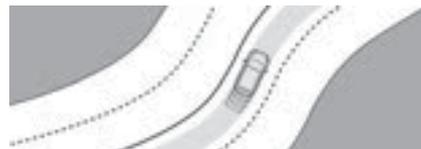
Ce système identifie les délimitations de la voie de circulation et pilote le véhicule à l'intérieur de cette voie pour le maintenir dans la position latérale choisie par le conducteur. Pour cela, le système utilise une caméra placée sur la partie supérieure du pare-brise. Ce système est principalement adapté à la conduite sur autoroutes et voies rapides.
