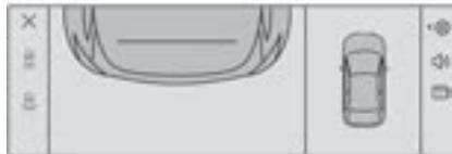
La caméra arrière enregistre les alentours lors de la manœuvre pour créer une vue de dessus arrière du véhicule dans son environnement proche, permettant de réaliser une manœuvre du véhicule avec les obstacles environnants.
