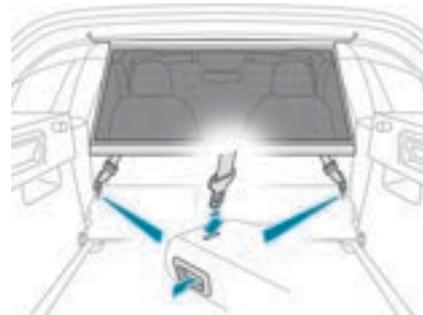
▶ Accrochez les sangles du filet aux points d'ancrage inférieurs, situés à l'aplomb des fixations de l'assise de la banquette arrière.
