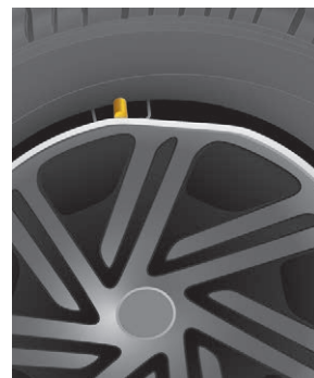
Déformation du bord de l'enjoliveur au niveau de la valve, à cause du mauvais montage.
