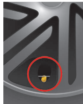
Position non conforme de la valve : au dessous de l'anneau.
