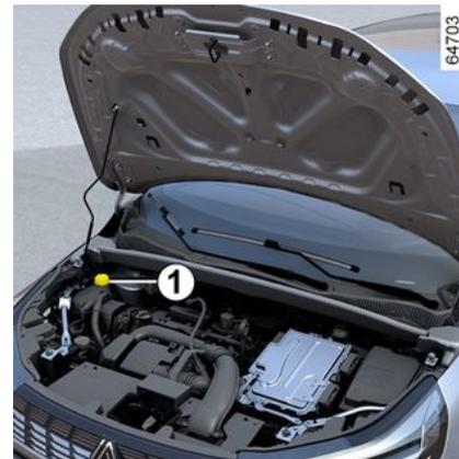
Contact coupé et sur sol horizontal, le niveau **à froid** doit se situer entre les repères « MINI » et « MAXI » indiqués sur le bocal de liquide de refroidissement **1**.
