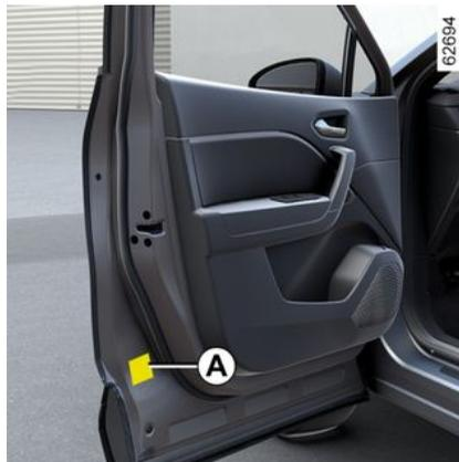
Pour la lire ouvrez la porte conducteur. Les pressions de gonflage doivent être vérifiées sur pneumatiques froids.
