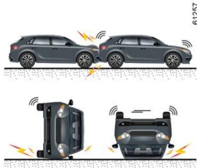
**Dans les exemples de cas suivants, les prétensionneurs ou les airbags sont susceptibles de ne pas être déclenchés :**
