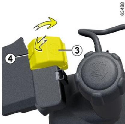
**Nota :** ouvrez le couvercle **3** du bornier **1 (+)** en appuyant sur le bouton **4** suivant flèche.
