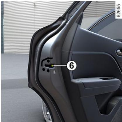
Porte ouverte, faites pivoter la vis **6** (à l'aide de l'embout de la clé) et fermez la porte.
