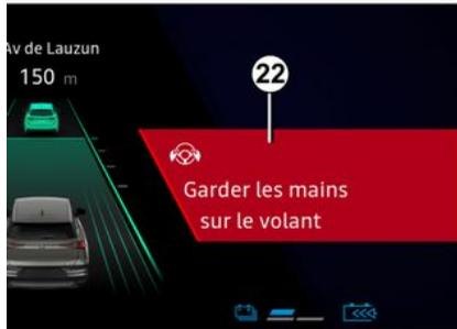
Lorsque la fonction « Centrage voie » ne détecte plus la présence de vos mains sur le volant, plusieurs niveaux d'alerte vont être effectués :
