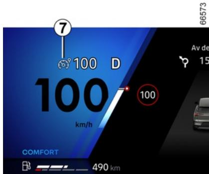
Appuyez autant de fois que nécessaire sur le contacteur **1** pour sélectionner le limiteur de vitesse **A**. Le témoin **7** s'allume en gris. Le message « Limiteur prêt : SET pour activer » apparaît au tableau de bord accompagné de tirets pour indiquer que la fonction limiteur de vitesse est en service et en attente de l'enregistrement d'une vitesse de limitation.
