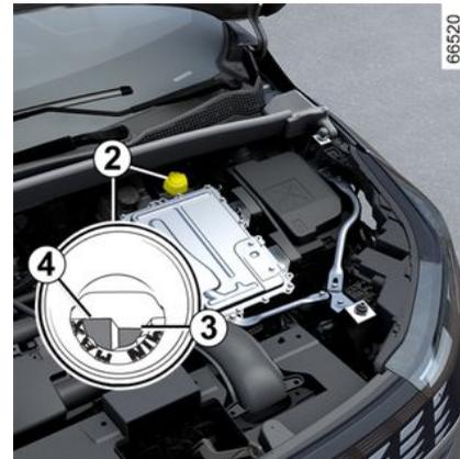
Ce circuit est différent de celui du moteur thermique. Il sert au refroidissement du moteur électrique.
