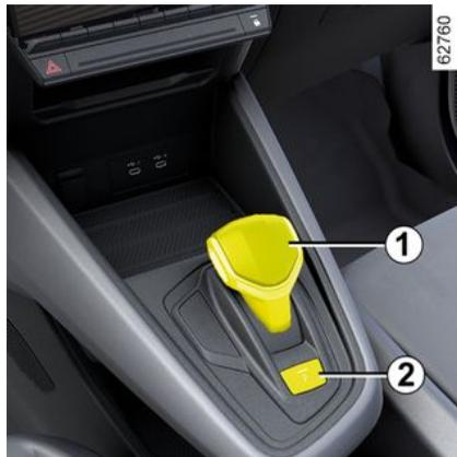
Véhicule à l'arrêt, moteur allumé ou contact mis, appuyez sur le bouton **2** pour engager la position **P**. Le témoin du bouton **2** s'allume en orange une fois la position parking **P** de la boîte de vitesses engagée.
