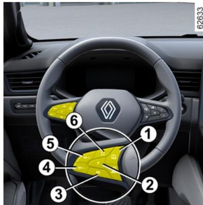
La fonction limiteur de vitesse est mise en veille lorsque vous agissez sur le contacteur **2** (0). La vitesse de limitation est mémorisée et affichée en gris au tableau de bord.
