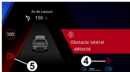
lorsqu'il y a un risque de collision avec un véhicule qui se trouve dans la zone d'angle mort **D** et se déplace dans la même direction que votre véhicule ou avec un véhicule qui s'approche rapidement par l'arrière sur une voie adjacente dans le périmètre de détection **E**, le système :
