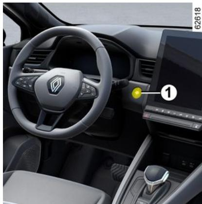
Appuyez sur le contacteur **1** sans appui sur les pédales pour la mise sous contact du véhicule. Appuyez sur la pédale de frein puis appuyez sur le contacteur **4** : le témoin **3** du contac-
