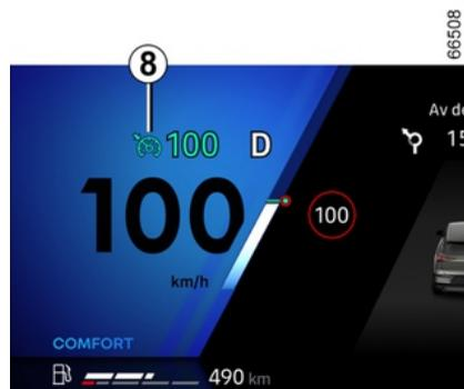
Appuyez autant de fois que nécessaire sur le contacteur **1** pour sélectionner le régulateur de vitesse **7**.
