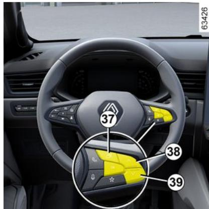
Appuyez sur le contacteur **37** pour accéder au Monde « Véhicule » **35**, puis faites des appuis sur le contacteur **38** ou **39** jusqu'à obtenir l'affichage **36**.
