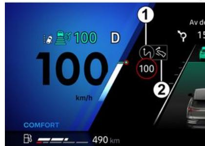
Avant la survenue d'une situation de conduite, les indicateurs **1** et **2** s'affichent au tableau de bord.
