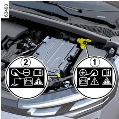
Utilisez le **bornier 1 (+)** et le **bornier 2 (-)** dans le compartiment moteur.
