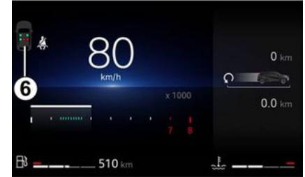
Portes fermées, le visuel **6** s'affiche au tableau de bord à la mise sous contact du véhicule pendant 60 secondes environ. Il indique au conducteur l'état de bouclage de chacune des ceintures avant à chaque :
