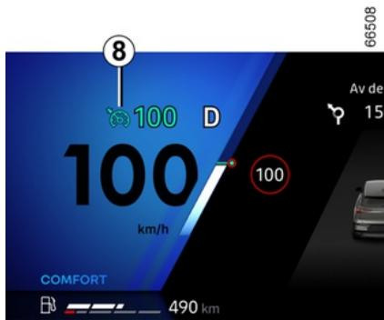
Lors du rappel de la vitesse mémorisée, l'activation du régulateur est confirmée par l'affichage en vert de la vitesse de régulation et, suivant véhicule, de l'allumage du témoin **8**.
