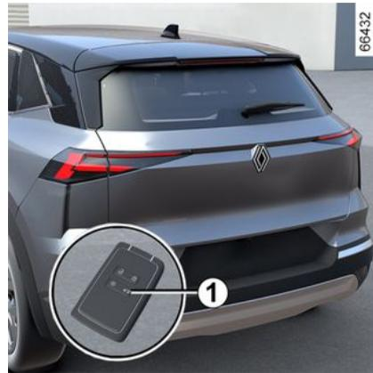
Moteur non tournant, faites un appui long sur le contacteur **1** de la carte, à proximité du coffre.
