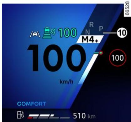
**Nota** : suivant véhicule, le retour au mode automatique s'effectue par un appui long sur la palette de droite, ou en basculant le levier impulsionnel **1** d'un ou deux crans vers l'arrière.
