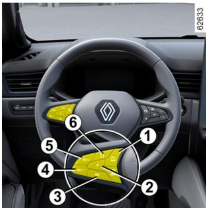
1. Contacteur de sélection/désélection des assistances de conduite, suivant
