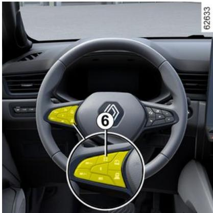
Pour adapter la consigne du limiteur de vitesse, du régulateur ou du régulateur de vitesse adaptatif aux limitations de vitesse détectées, appuyez sur le contacteur **6**.
