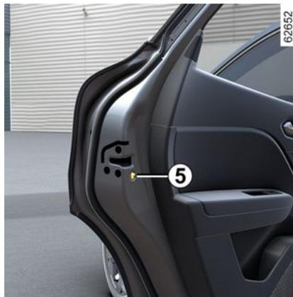
Pour rendre impossible l'ouverture des portes arrière de l'intérieur, déplacez le levier **5** et vérifiez de l'intérieur que les portes sont bien condamnées.
