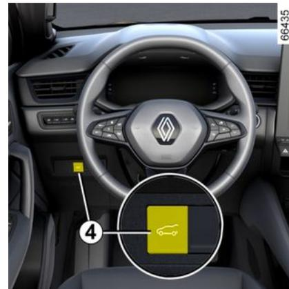
Pour déclencher l'ouverture du hayon, faites un appui long sur le contacteur **4** jusqu'au signal sonore puis relâcher immédiatement le contacteur.
