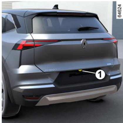
Au passage de la marche arrière, la caméra **1** située à l'arrière du véhicule transmet une vue de l'environnement arrière du véhicule sur l'écran multimédia **2** accompagné d'un à trois gabarits **3**, **4** ou **5** (fixe, mobile et remorque).
