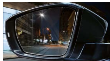
Détecteur d'angle mort 'Blind spot Detection'
