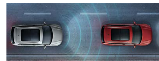
ACC : régulateur de vitesse adaptatif
