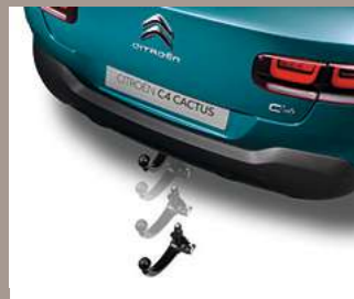
ATTELAGE AVEC ROTULE DÉMONTABLE SANS OUTILS
